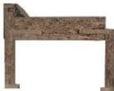
průřez reverzní zárubní
